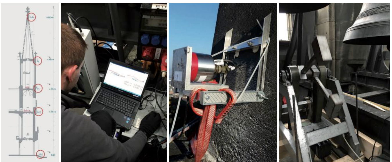
Abb. 4 Schwingungsmessungen, Positionen Messsonden und Einrichtung mit Umwucher im Oktogon. Zeichnung Ingenieurgruppe Bauen, Fotos Stiftung Basler Münsterbauhütte
